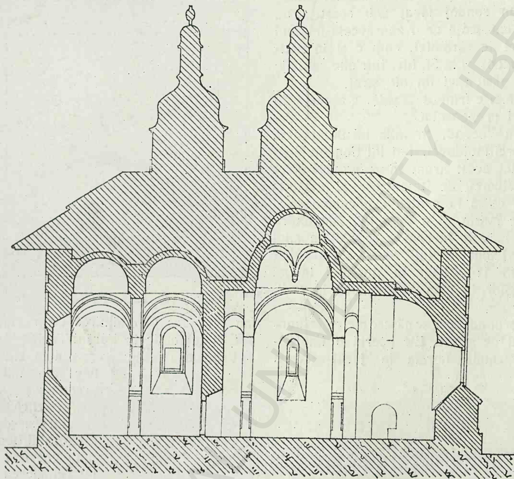
Fig. 100. Războeni, Secțiune longitudinală, (releveul „Arta Românească“)
