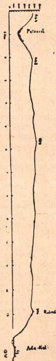
Fig. 1. — Drumul pe creasta muntelui dela Petrosel la Ada-Kal. Înălțimea e exagerată indoit cât lungimea (după Harta St. Maj. Sârb 1/75,000 — Echidistanța curbelor 50 m.)
